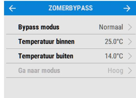
De instelling voor binnentemperatuur is de maximale gewenste kamertemperatuur. Deze moet 3° boven de temperatuur van de centrale verwarming worden ingesteld.
