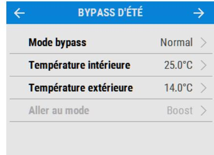
Le paramètre de température intérieure représente la température maximum souhaitée dans la pièce. Elle doit être réglée à 3° au-dessus de la température du chauffage central.
