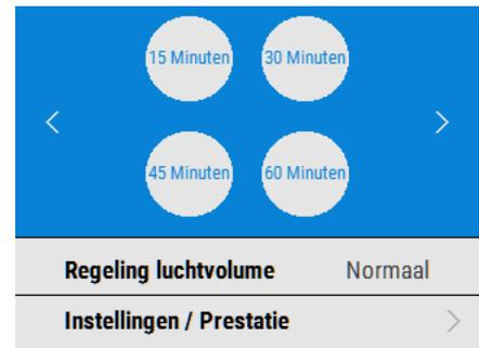
De knop wordt wit en de gebruikersmodus gaat knipperen. Er verschijnt een aftelklok die de resterende looptijd voor de geselecteerde gebruikersmodus aangeeft.
